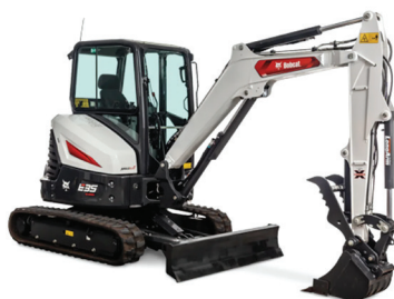
BOBCAT E35 3.8 TON - 25 HP - 11' DIG DEPTH 18' REACH
